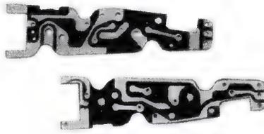
Bild 6. Schaltplatten einer Hörbrille (Siemens)
