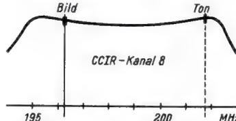
Bild 3. Anzustrebende Durchlaßkurve des Kanalwählers
