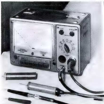
Bild 3. Grundig-Universal-Röhrenvoltmeter Typ 6062
