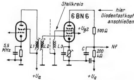
Bild 7. Abgleichschema eines FM-Demodulators mit der Röhre 6 BN 6
