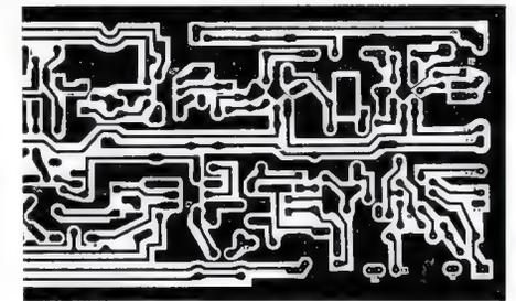
Bild 3. Ausschnitt einer stark verkleinerten „Musterzeichnung“ für die gedruckte Schaltung in einem Fernsehempfänger
