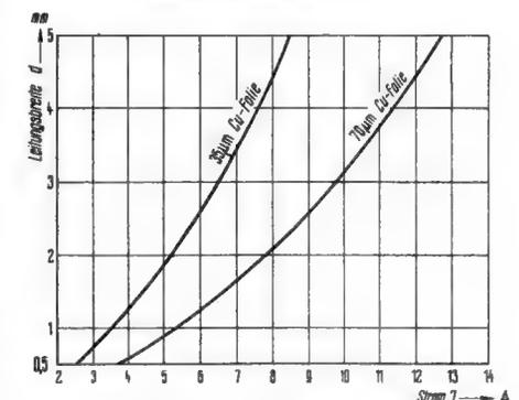
Bild 4. Belastbarkeit gedruckter Leitungen mit verschiedener Kupferstärke
