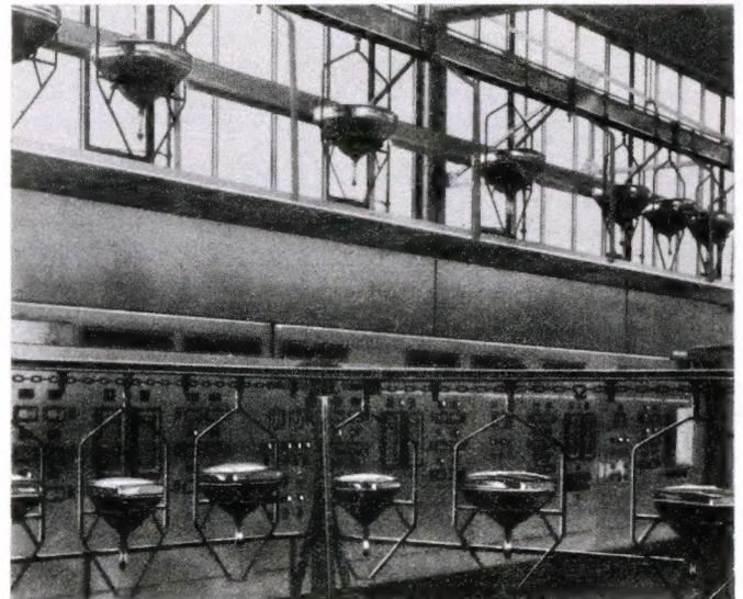
Elektronische Schalt- und Kommandostände steuern automatisch den Fertigungsablauf und garantieren eine gleichmäßige Qualität der TELEFUNKEN-Bildröhren.
