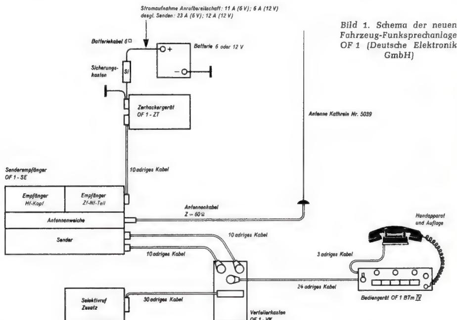
Bild 1. Schema der neuen Fahrzeug-Funksprechanlage OF 1 (Deutsche Elektronik GmbH)
