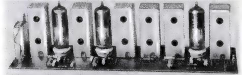
Bild 9. Beispiel für einen Bild-Zf-Verstärker mit gedruckter Schaltung (Valvo)
