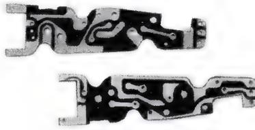
Bild 6. Schaltplatten einer Hörbrille (Siemens)
