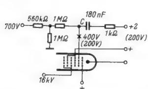
Zu: Geringe Bildhelligkeit. Der Kurzschluß im Kondensator C ließ die Schirmgitterspannung von 400 auf 200 V zusammenbrechen, das Bild war deshalb zu dunkel
