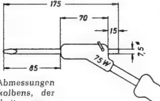
Bild 10. Abmessungen eines Lötkolbens, der sich bei Arbeiten an gedruckten Schaltungen bewährt hat (Zeva)
