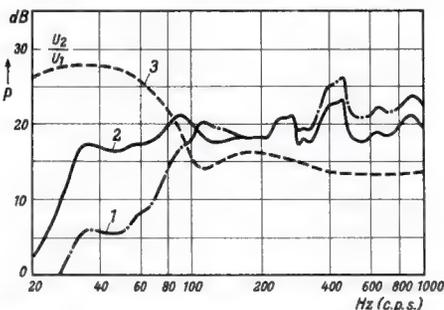
Bild 2. Schalldruck-Frequenzgang und Entzerrung der Truhe „Prima Ballerina“. Kurve 1 = Schalldruck-Frequenzgang ohne Entzerrung, Kurve 2 = Frequenzgang des Verstärkers, Kurve 3 = Kombination aus den Kurven 1 und 2
