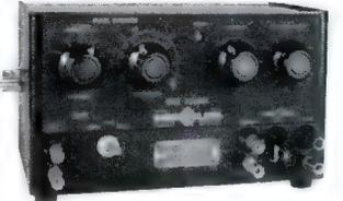
Ein kleiner, vielseitiger und preiswerter Impuls-generator. Pulsfrequenz: 15 Hz bis 100 kHz. Pulsdauer: 0,2 bis 60000  $\mu$ s. Anstiegszeit: 0,05  $\mu$ s. Ausgang: 200 und 1500  $\Omega$ , 20 bis 50 V. Steuerung: Eingebauter Generator für 25 Hz, 50 Hz, 100 Hz bis 100 kHz in Stufen 1, 2, 5 . . . . . Kontinuierliche Steuerung von 15 Hz bis 100 kHz durch äußeren Generator möglich. DM 1375.-
