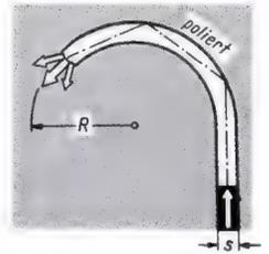
Bild 2. Damit im Bogenstück kein Licht austritt, darf dort das Licht nirgends steiler als unter 42° auf die Wand auftreffen
