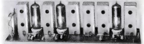
Bild 9. Beispiel für einen Bild-Zf-Verstärker mit gedruckter Schaltung (Valvo)
