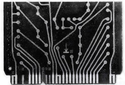
Bild 8. Leiterplatte für eine Flachbaugruppe in einem Digital-Rechner mit Kontaktleiste (Siemens)
