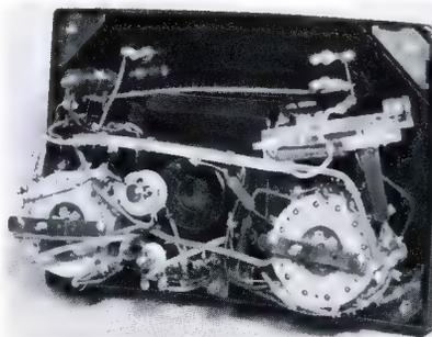
Bild 1. Philips-Universalmeßinstrument P 817 – Innenansicht. Die Außenansicht erschien bereits in der FUNKSCHAU 1958, Heft 6, S. 147
