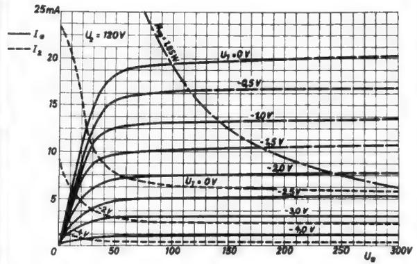
Anoden- und Schirmgitterstrom als Funktion der Anodenspannung
