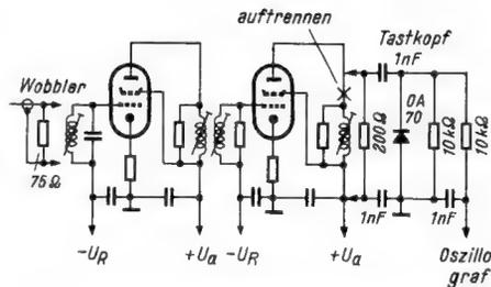
Bild 6. Abgleichschema für bandfiltergekoppelte Zf-Stufen
