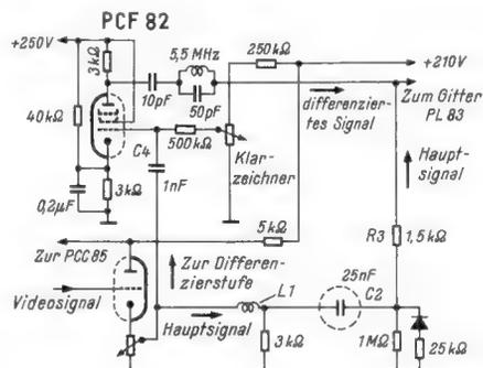
Der eingekreiste Kondensator C 2 war schadhaft und sperrte den einen Weg des Videosignals
