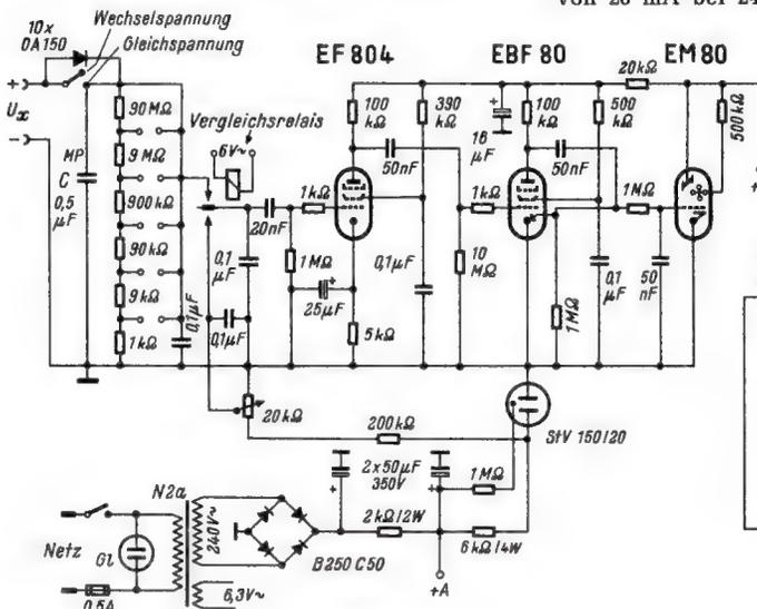
Bild 1. Schaltung des Brücken-Röhrenvoltmeters
