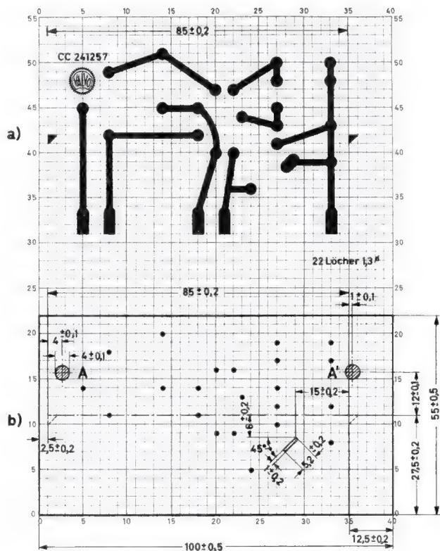
während Hilfslinien und dergl. zu vermeiden sind. Der schwache blaue Druck des Rastergitters kann bei dem folgenden fotografischen Vorgang leicht unterdrückt werden. Mitgedruckt werden jeweils Paßkreuze, die zur Toleranzkontrolle dienen. Überdies ist noch mancher spezielle Kniff in der Flächenaufteilung usw. zu beachten, worüber hier aus Raumgründen nicht gesprochen werden soll.
